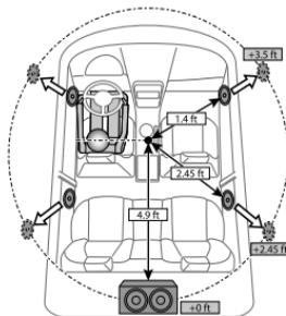
Si vous spécifiez la distance à partir du centre de la position d'écoute actuellement réglée sur n'importe quel réglage, la temporisation est calculée automatiquement et réglée.
