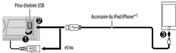
**KW-R935BTS:** Vous pouvez aussi faire une connexion au câble USB à partir de l'arrière de l'appareil.
