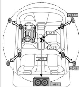
Si especifica la distancia desde el centro de la posición de escucha seleccionada hacia cada altavoz, el tiempo de retraso se calculará y ajustará automáticamente.
