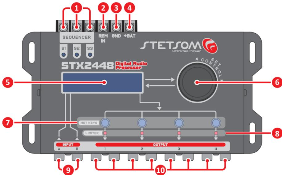
**1. SEQUENCER:** Permite o acionamento sequenciado de outros produtos através da conexão de acionamento remoto (REM). Utilize um cabo de no mínimo **0,75mm<sup>2</sup>**.
