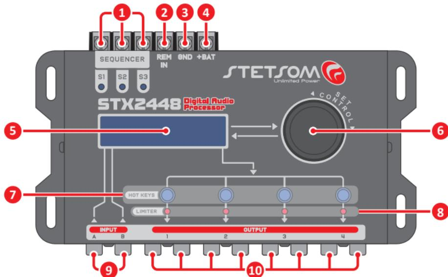
**1. SEQUENCER:** Permite la activación secuencial de otros productos a través de la conexión de activación remota (REM). Use un cable de al menos **0,75mm<sup>2</sup>**.
