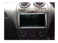
Fit the double din metal bracket.
